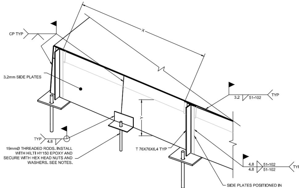
**TYPICAL SIDE PLATE INSTALLATION DETAIL**
