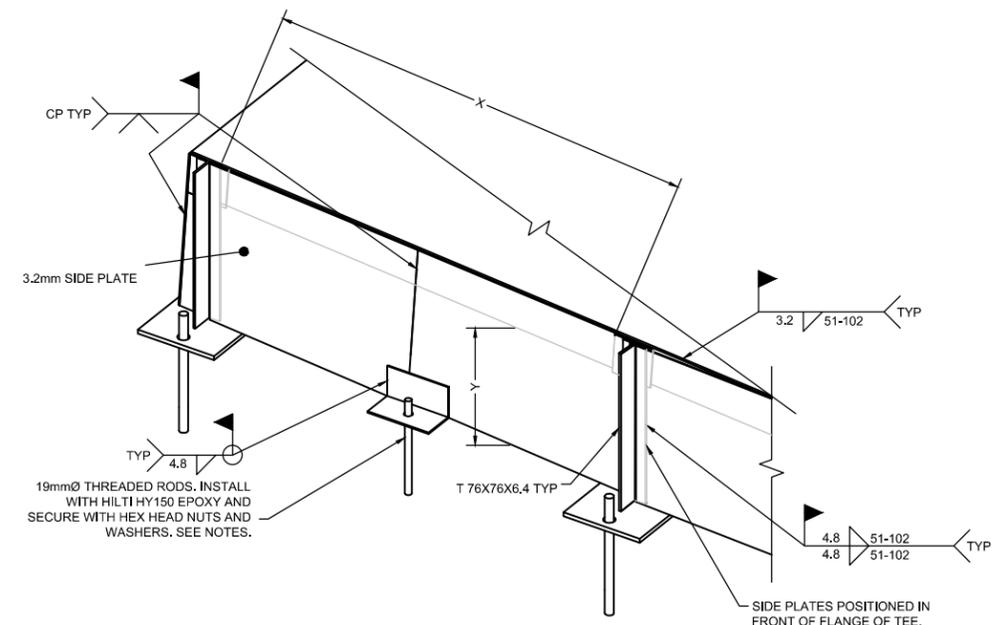
**TYPICAL SIDE PLATE INSTALLATION DETAIL**
